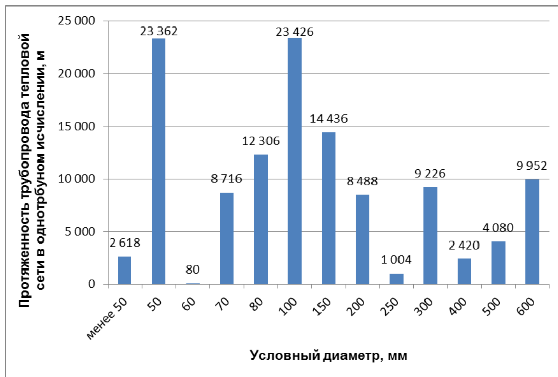
Рисунок 1.2 – Распределение протяженности трубопроводов тепловых сетей ООО «БашРТС» по диаметрам
