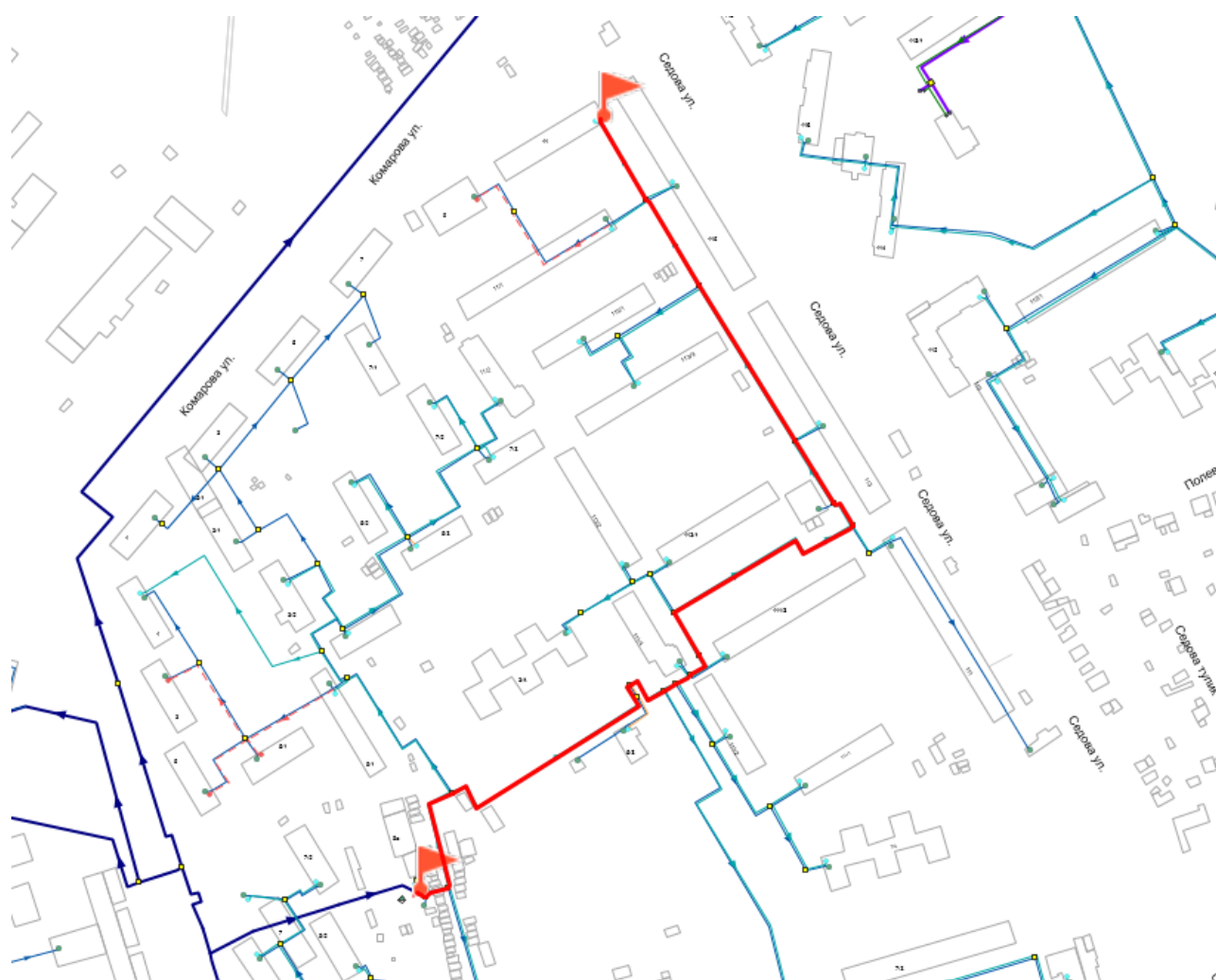
Рисунок 2.15 - Путь теплоносителя по направлению от «ЦТП – 6» до потребителя «ул. Комарова, 11»
