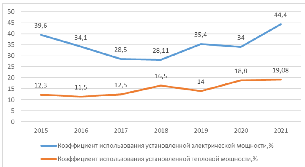
Рисунок 2.3 – Коэффициенты использования электрической и тепловой установленной мощности Приуфимской ТЭЦ
