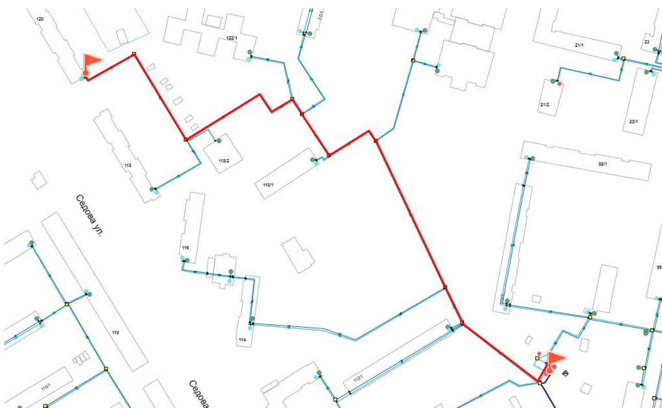
Рисунок 2.11 - Путь теплоносителя по направлению от «ЦТП – 7» до потребителя «ул. Седова, 120»
