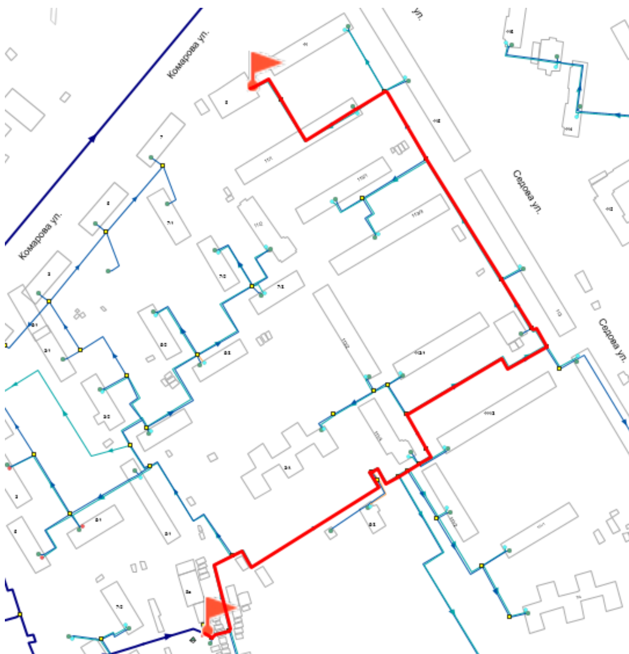
Рисунок 2.15 - Путь теплоносителя по направлению от «ЦТП – 6» до потребителя «ул. Комарова, 9»
